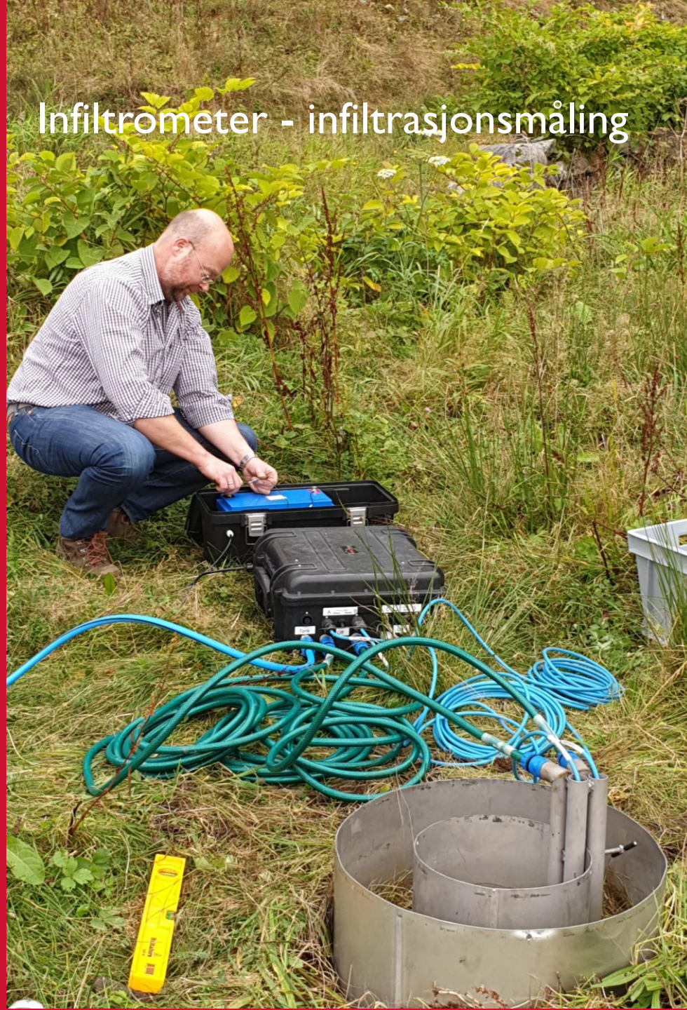
Måling av infiltrasjonskapasitet, Starefossen, Bergen - Foto: NVE
