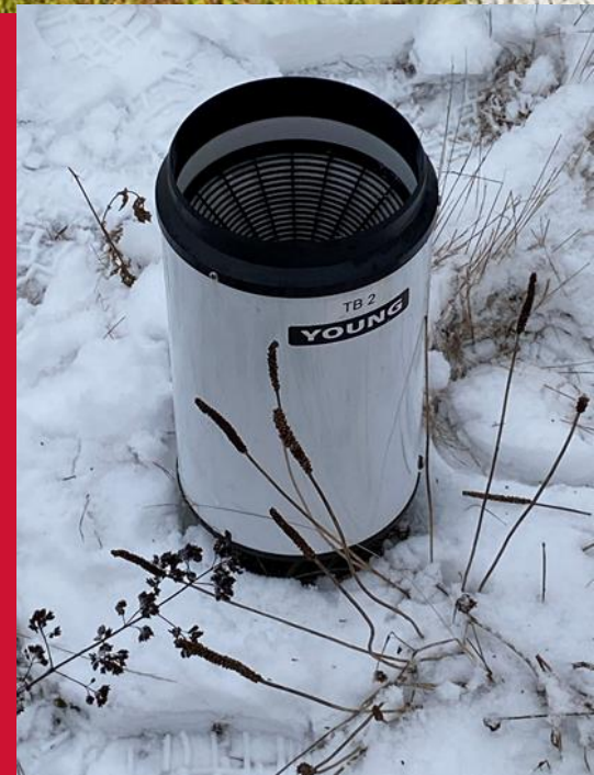
Nedbørmåler på det blågrønne taket på Vega scene Foto: NVE
