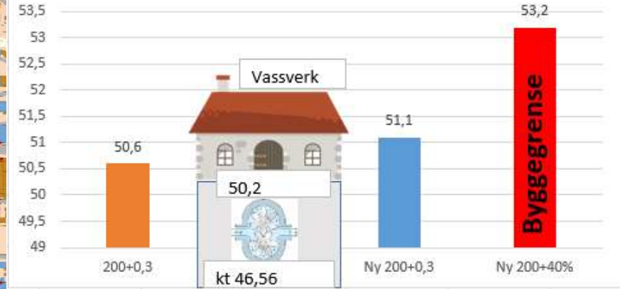
Byggjegrense før og etter flaumen, basert på rev. flomberegning fra NVE (062.Z) 56-2015 (J Håheim)
